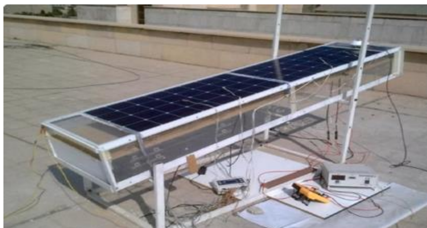
Сурет 1.21 – Вентилятор көмегімен конвективті салқындатуды қамтамасыз ету [77, б. 15]
