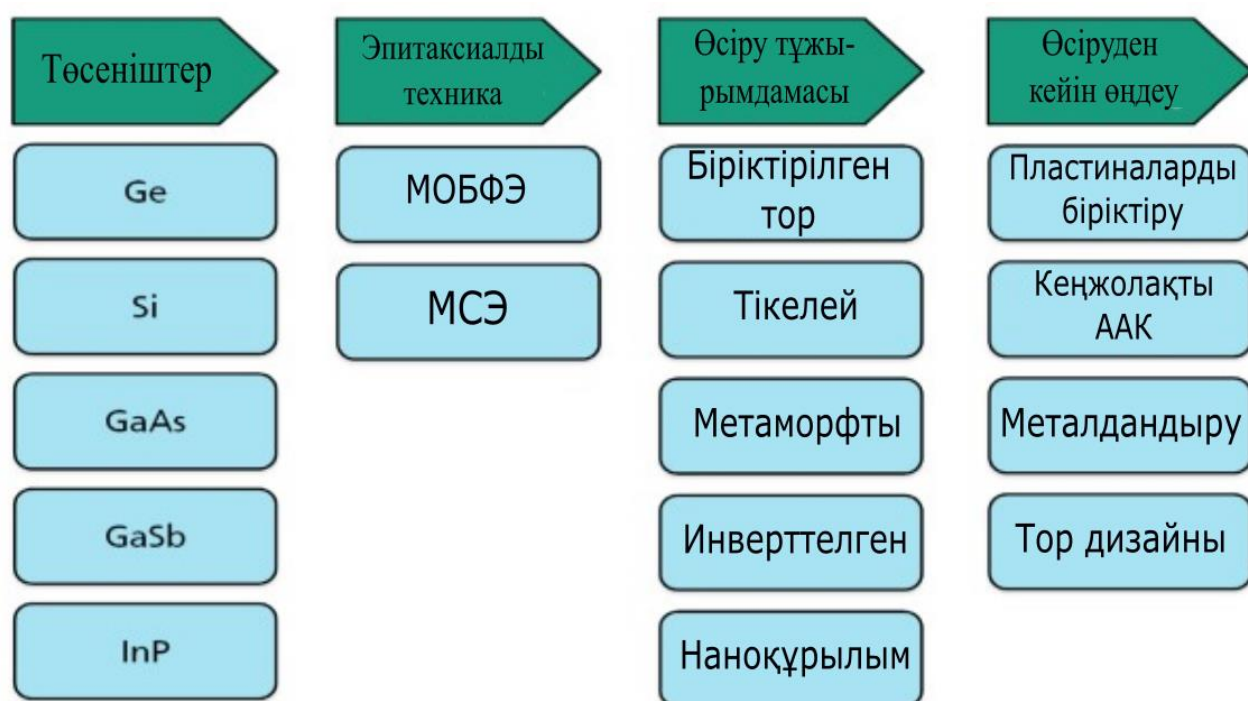
Сурет 1.2 – Көп-ауыспалы фотоэлементтерінің материалдары мен жасалу технологиялары [20, б. 041601-9]
