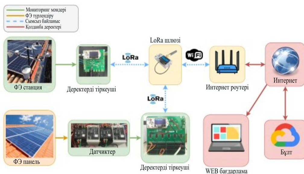
Сурет 1.26 – IoT негізіндегі фотоэлектрлік станцияны бақылау және басқару жүйесі [85, б. 3]
